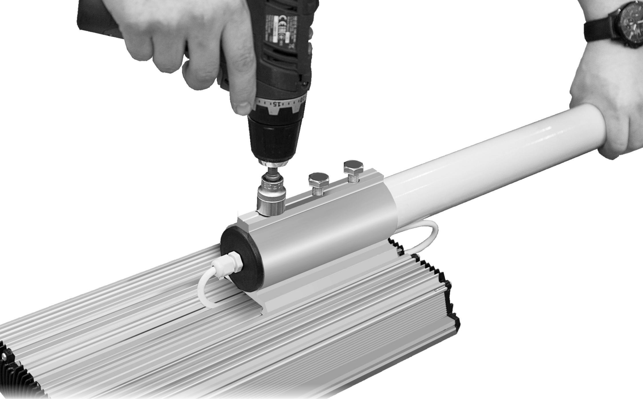
Закрепить кронштейн крепления тремя зажимными болтами.
