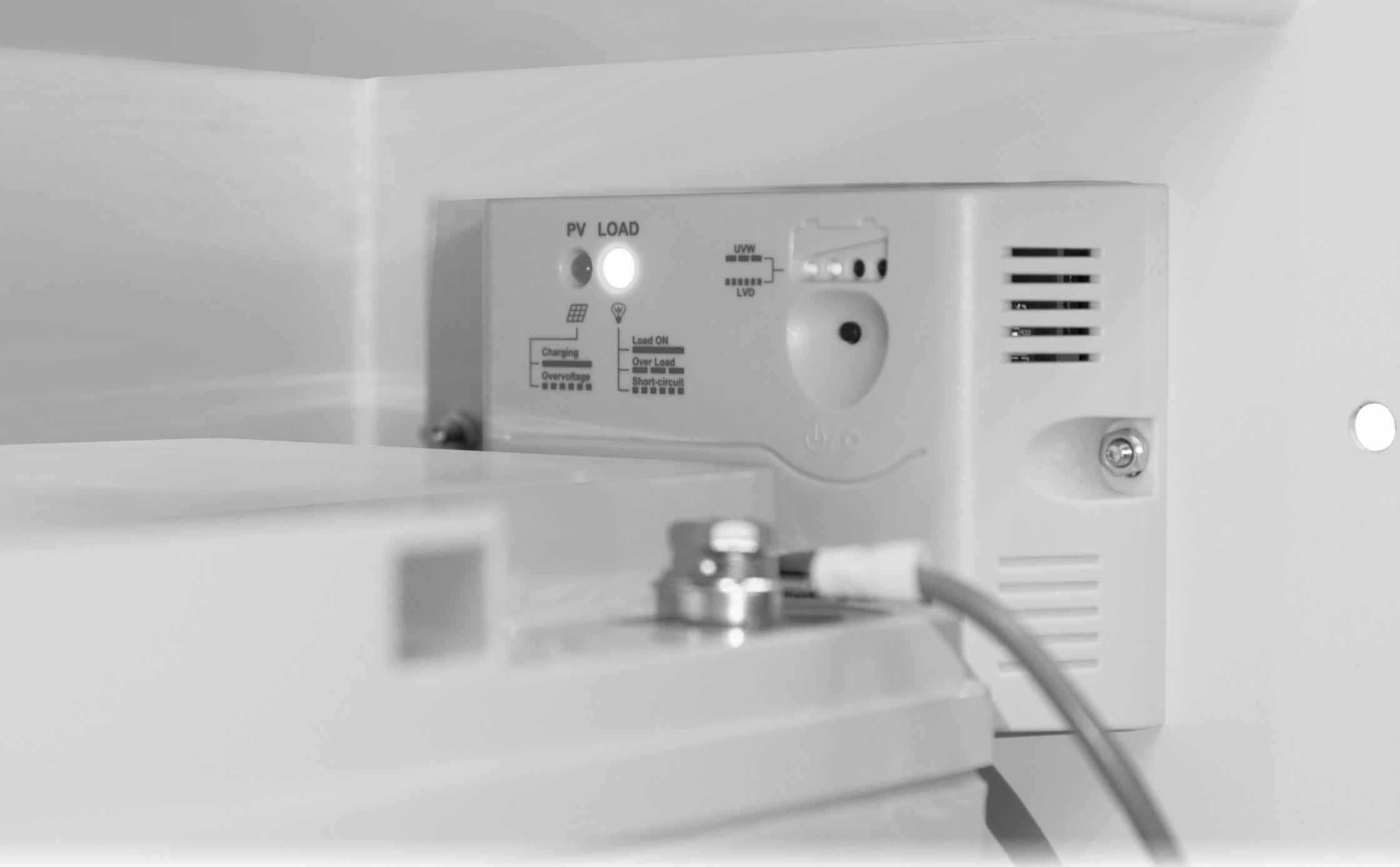
При правильном подключении аккумуляторной батареи, на контроллере загорается зеленый индикатор «LOAD»
