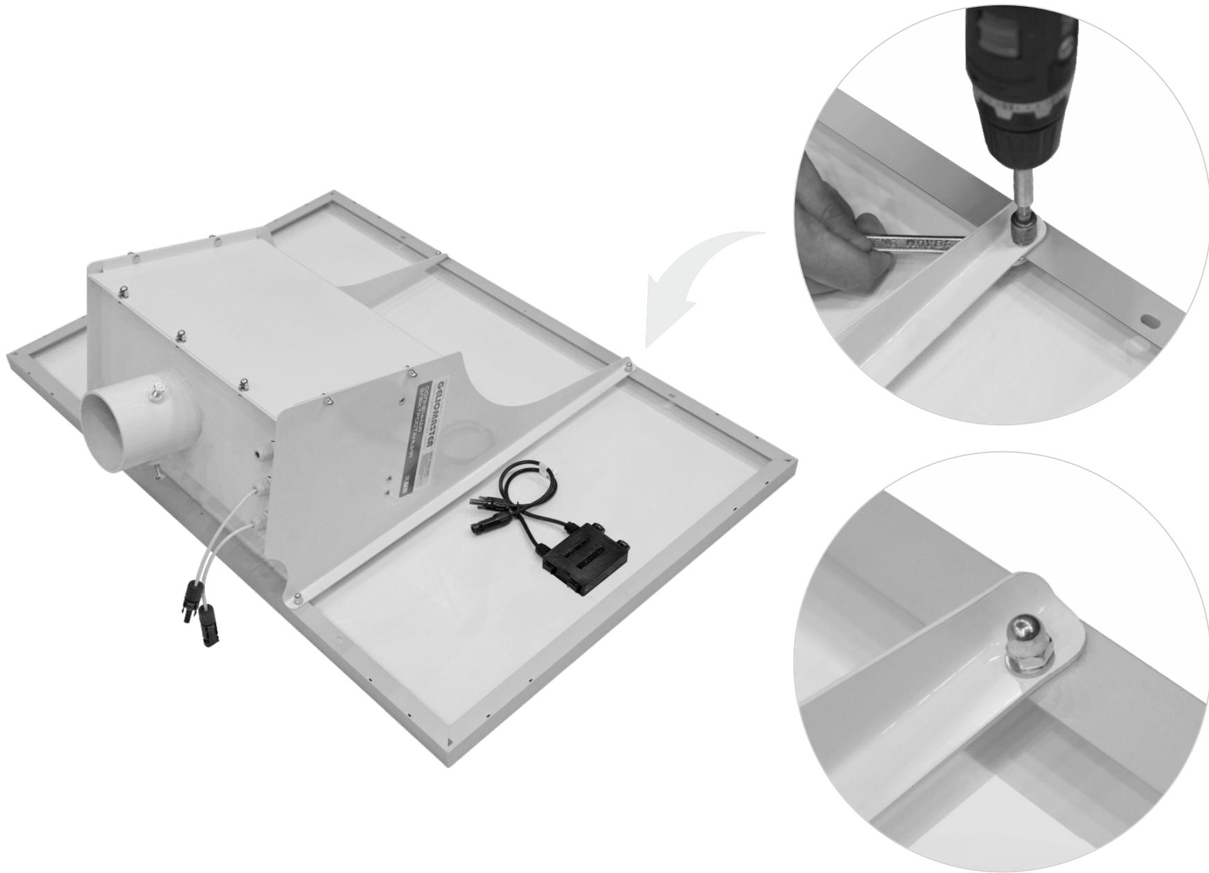
Солнечную панель закрепить на ящике для аккумуляторной батареи с помощью болтов, шайб и гаек.
