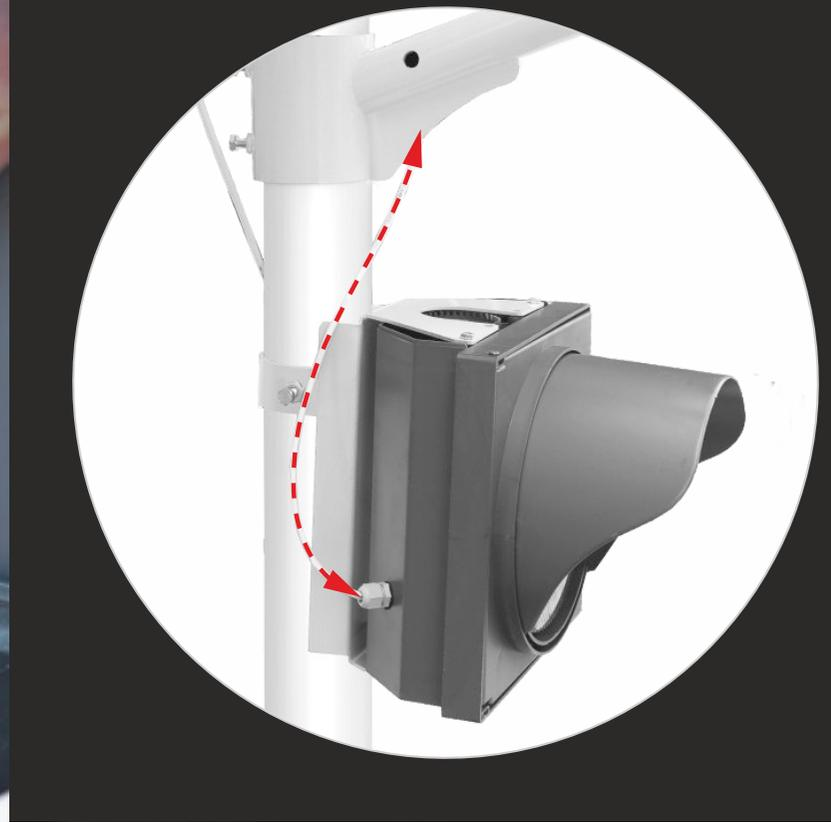
Продеть провод питания от светильника через гермоввод светофора и подключить к клеющей колодке. Коричневый провод к коричневому, синий к синему.
