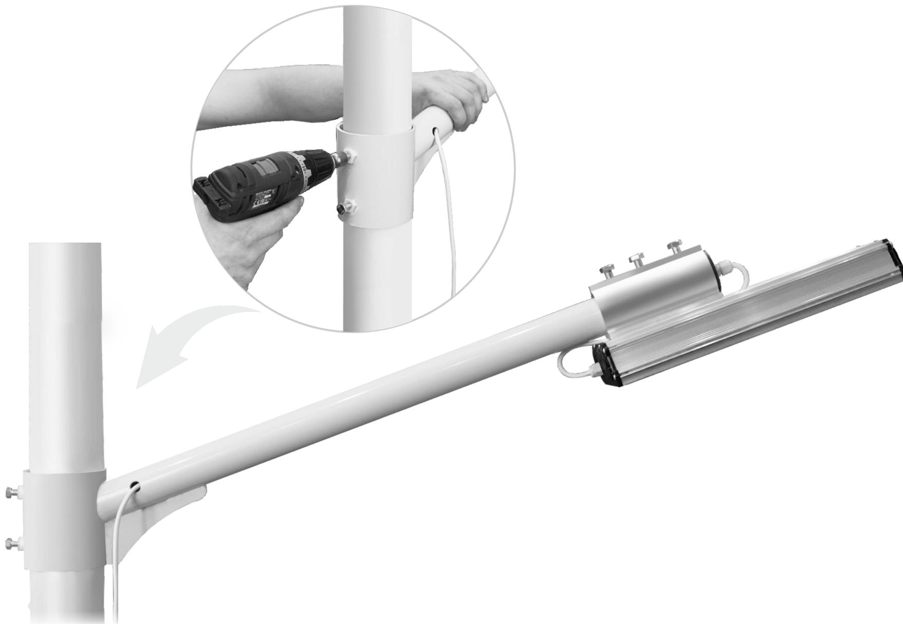
На опорный столб сверху надеть светильник с кронштейном крепления, отступив от начала столба примерно 40 см. Зафиксировать светильник на столбе зажимными болтами.
