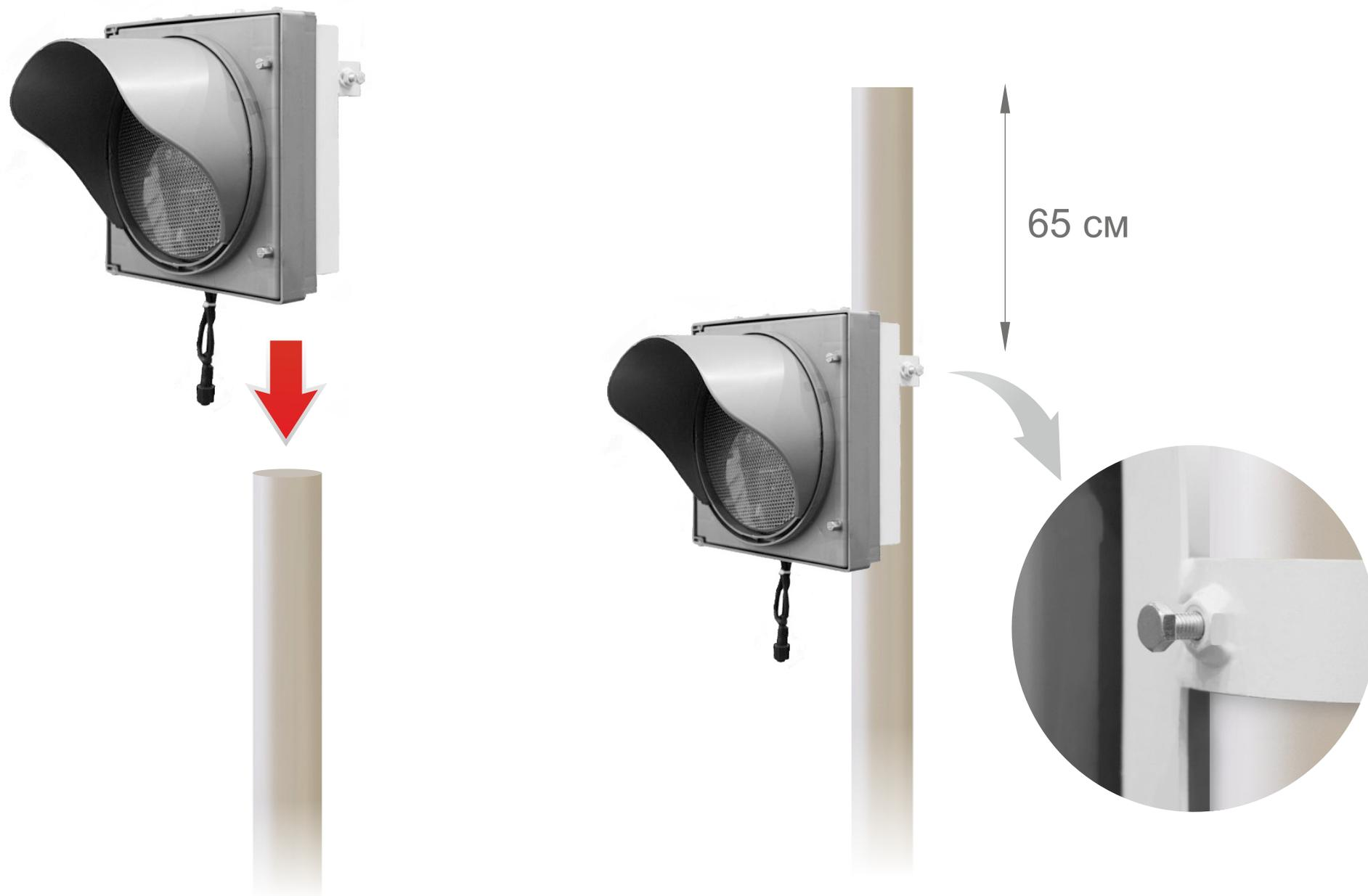
На опорный столб сверху надеть светофор с кронштейном крепления, отступив от начала столба примерно 65 см. Зафиксировать светофор на столбе двумя зажимными болтами.
