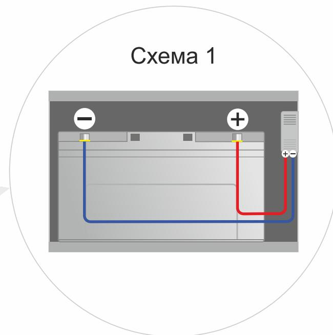
Подсоединить к клеммам аккумулятора кабель, идущий от клемм контроллера, как показано на схеме 1.
