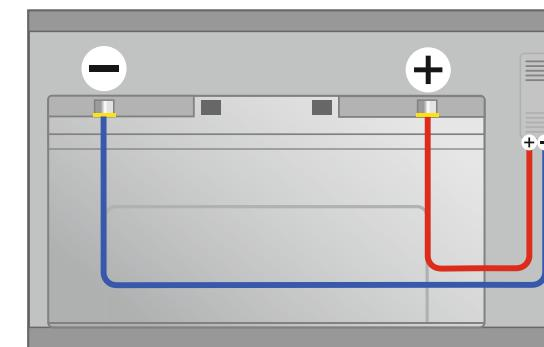
Подсоединить к клеммам аккумулятора кабель, идущий от клемм контроллера, как показано на схеме 1.
