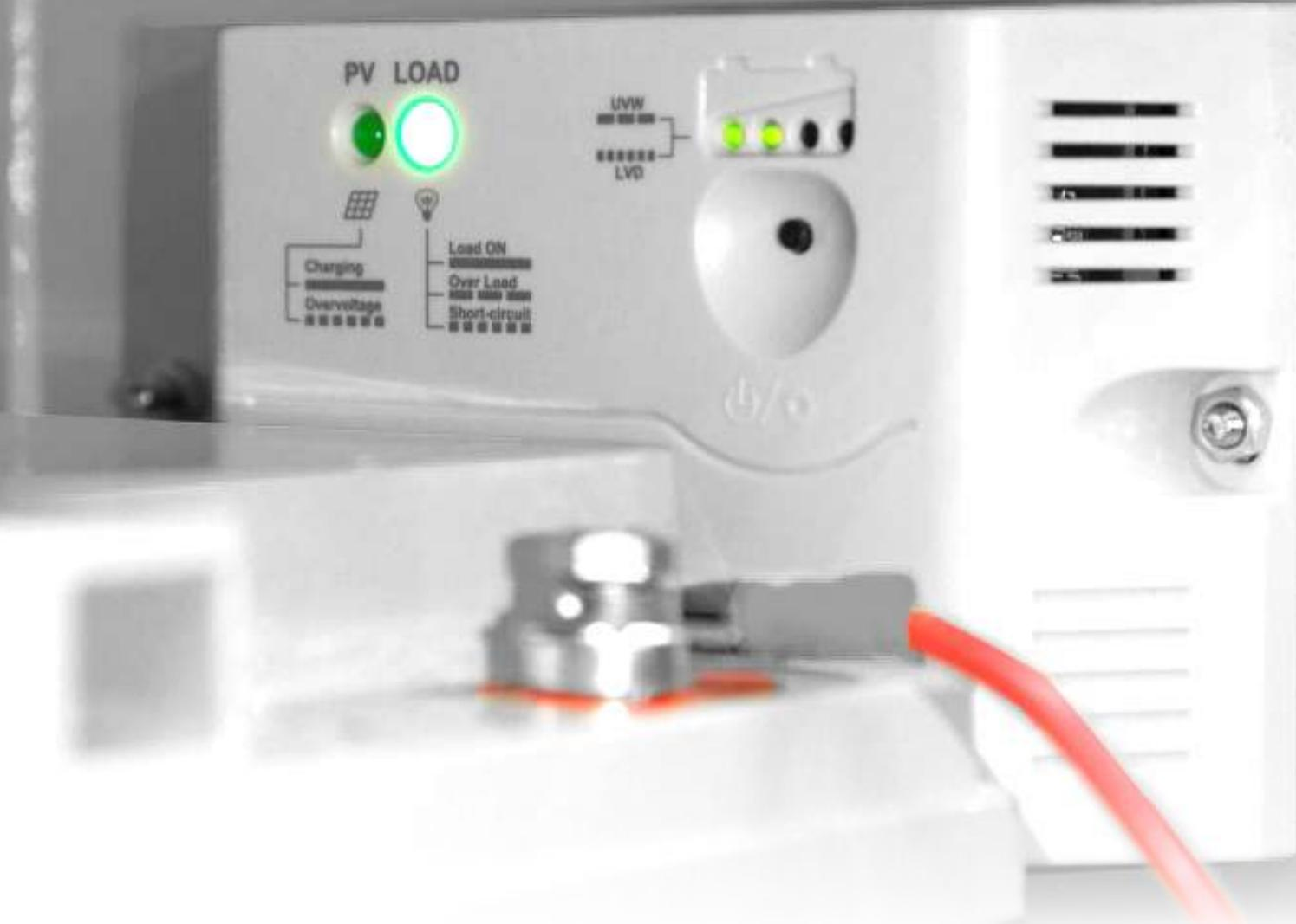
При правильном подключении аккумуляторной батареи, на контроллере загорается зеленый индикатор «LOAD».
