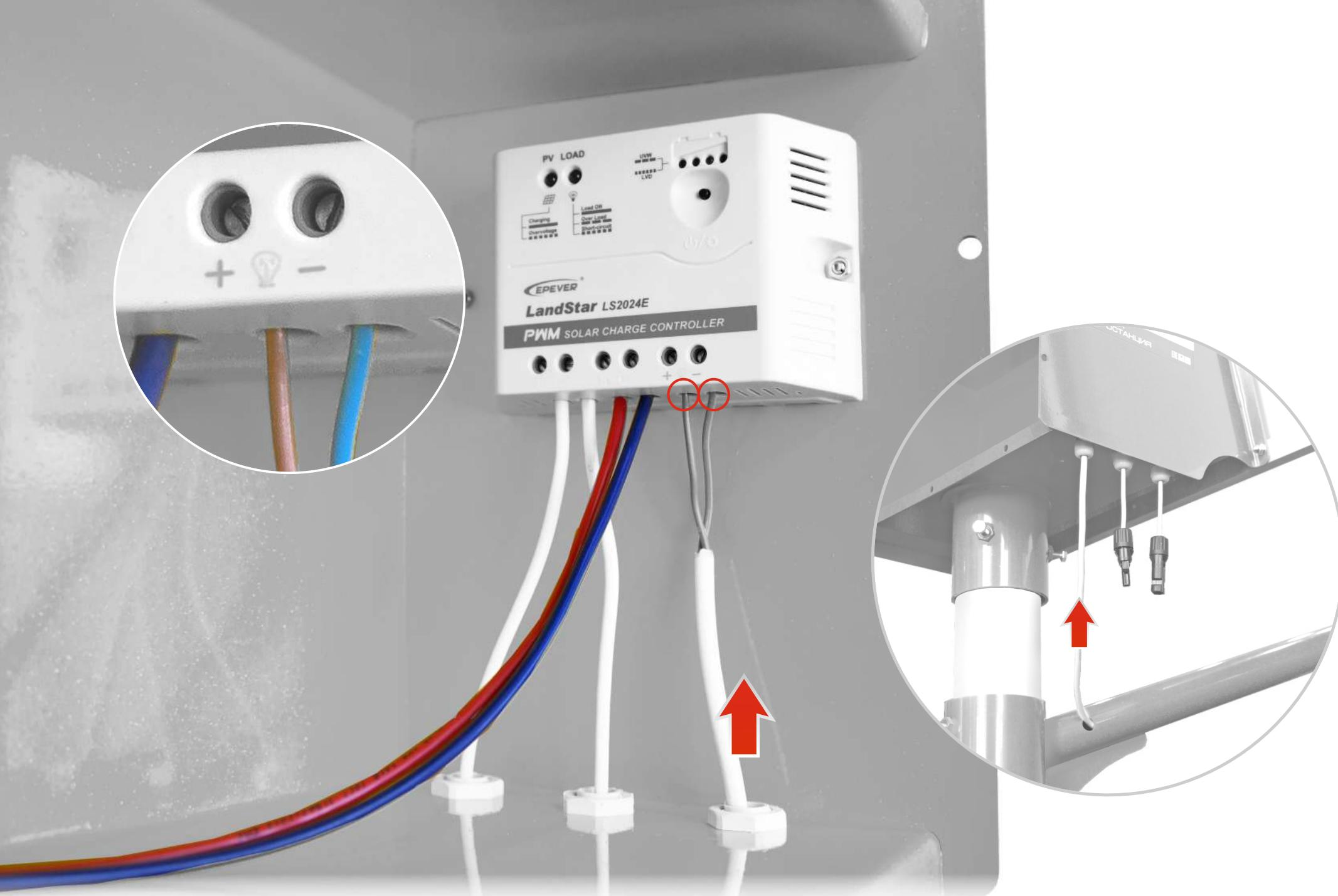
Подключить провода питания светильника к контроллеру.
