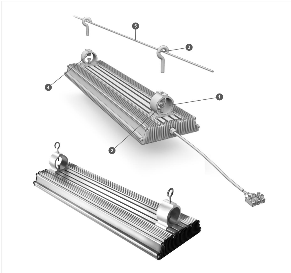
Рисунок 1. Схема монтажа светильника GSSN.
