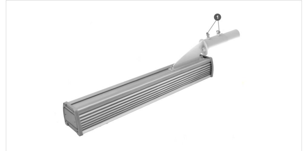
Рисунок 3. Схема монтажа светильника GSUM на консольное крепление.
