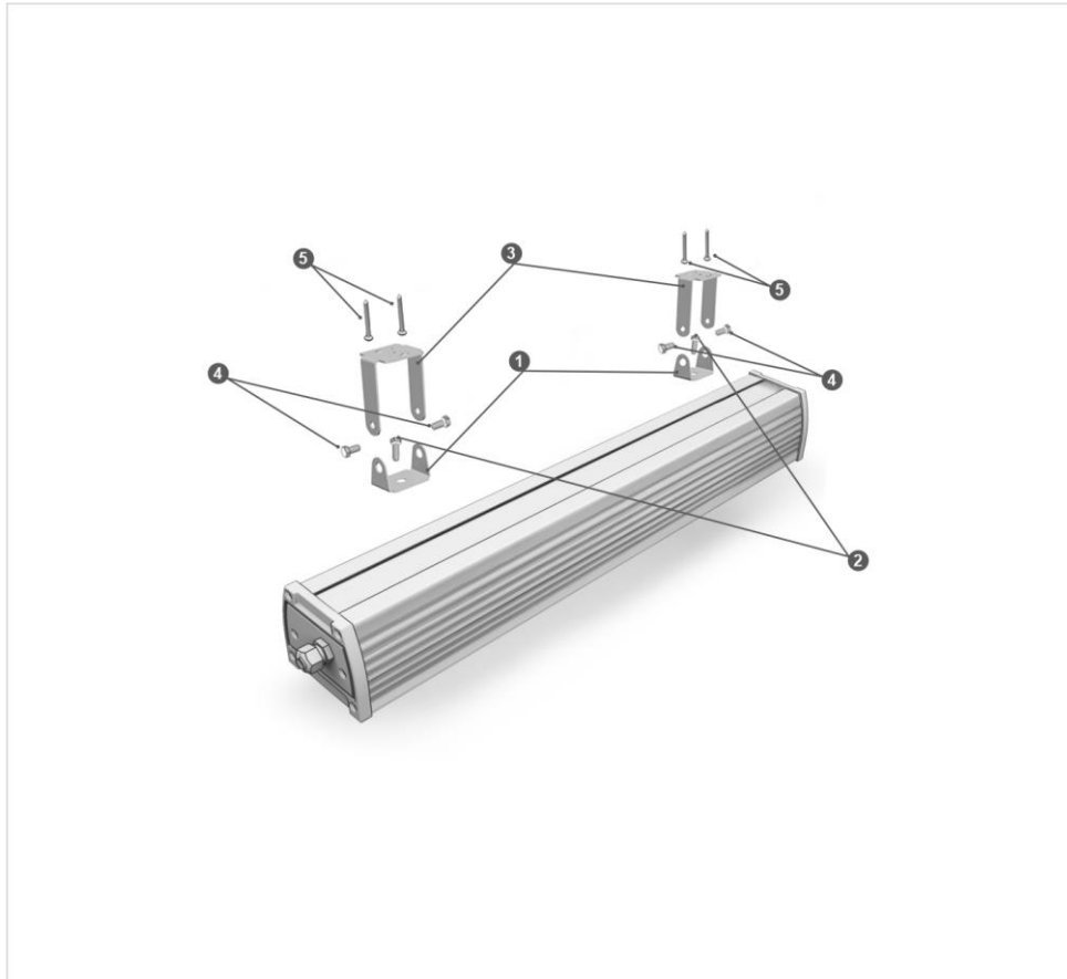
Рисунок 1. Схема монтажа светильника GSUM на потолочно-поворотное крепление.
